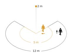
Hauteur d'instal lation: 1,80 m - 4,00 m Orange: sens de passage radial Noir: sens de passage tangentiel
